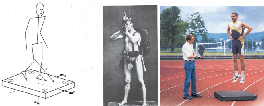
Figura 3. Plataforma dinamométrica. A: esquema registro de fuerzas, B. Soldado de la primera guerra mundial sobre una plataforma de fuerzas, C. Plataforma de fuerzas portátil especial para la medida del salto vertical.
